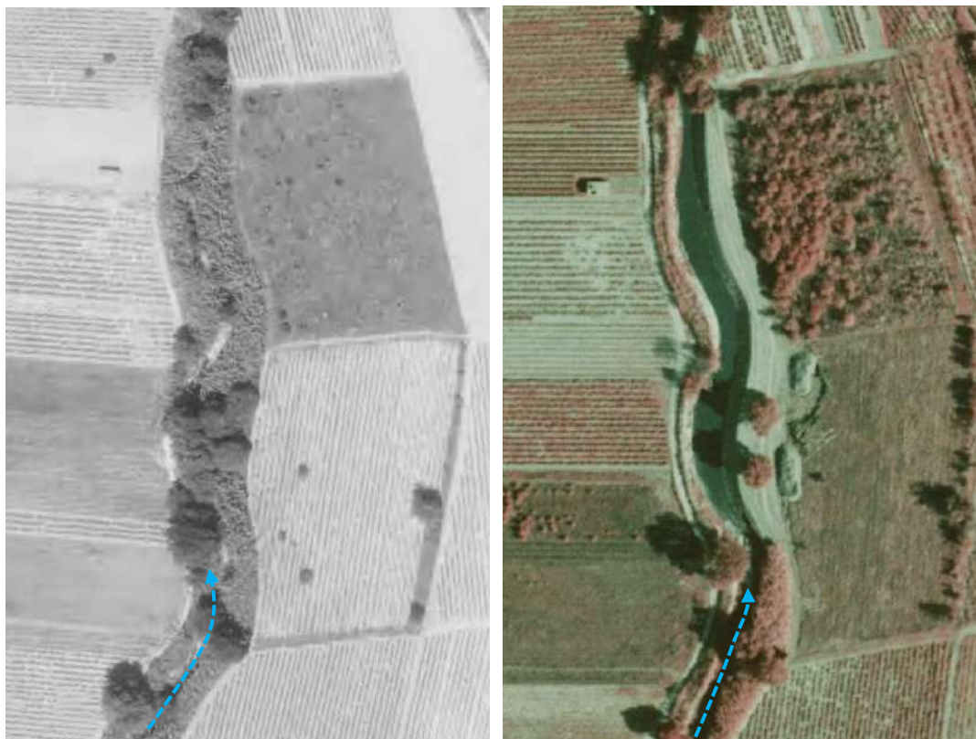
Figure 31 : Illustration des types de travaux : à gauche, 1978 - à droite, 1982 : les images sont à la même échelle. Ici, à l'amont de la confluence avec la Môle : recalibrage, élargissement du lit mineur, curage des atterrissements, création de formes sont plus « hydrauliques », mise en place d'enrochements et création d'un merlon largement épaulé (en rive droite à tout le moins), maintien de rares arbres. Ces types de travaux ont concerné la Giscle entre le pont de la RN98 et la confluence avec la Grenouille.
