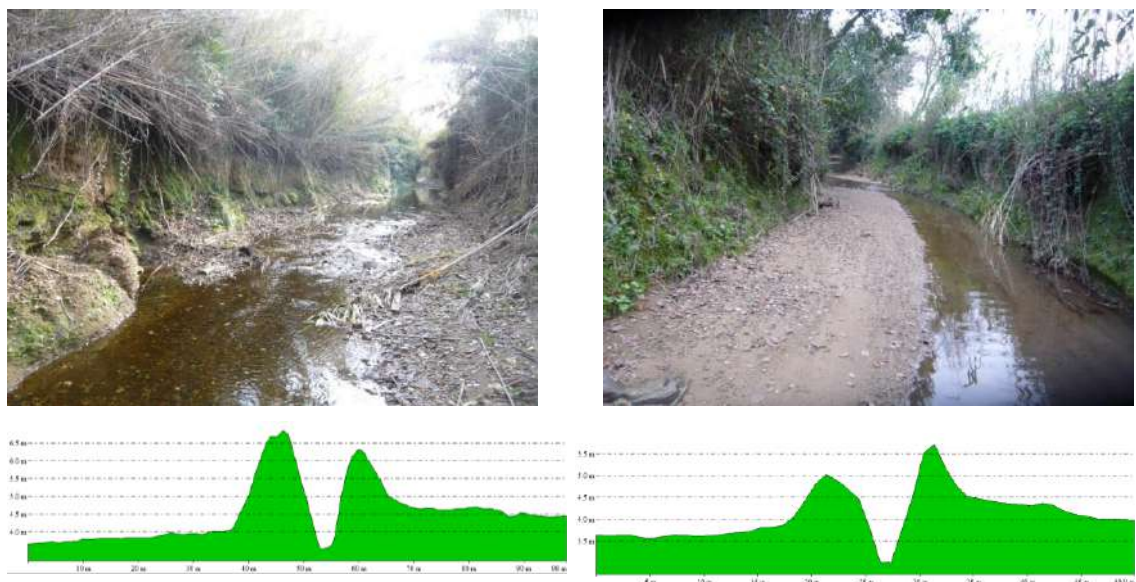
Figure 36 : Représentation de l'état actuel sur deux profils en travers (à gauche sur le Bourrian, à droite sur le Bélieu) et photographies des secteurs
